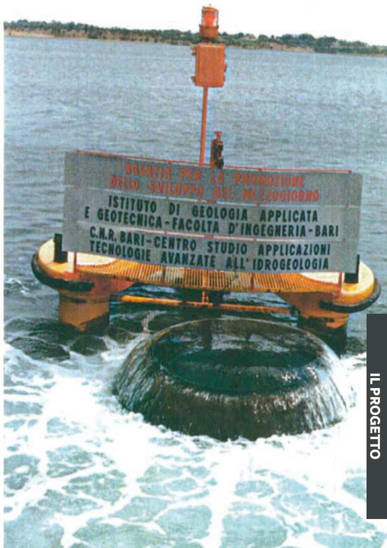
Sistema di captazione delle acque del citro "Leggiadrezze" di Mar Piccolo sperimentato negli anni Novanta (Fonte Uniba)
